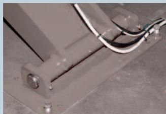
Biseau réduisant l'angle de la rampe à 8° pour un accès facile des véhicules surbaissés.
